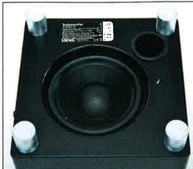
Den Downfiring-Subwoofer kann jeder Amateur ins System integrieren, denn es genügt ein Stromkabel.
