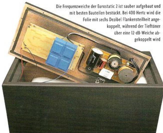
Die Frequenzweiche der Eurostatic 2 ist sauber aufgebaut und mit besten Bauteilen bestückt. Bei 400 Hertz wird die Folie mit sechs Dezibel Flankensteilheit angekoppelt, während der Tieftöner über eine 12-dB-Weiche abgekoppelt wird
